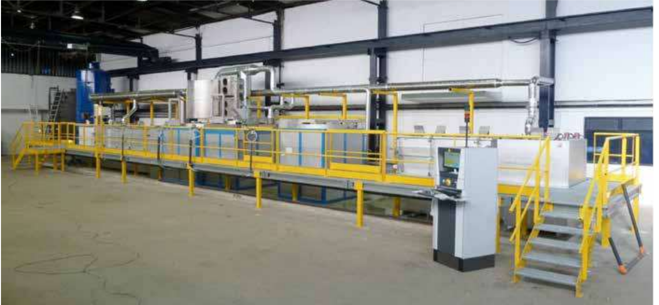
TUFFTRIDE®-/QPQ® sürecini yürütmek için bilgisayar kontrollü tuz banyosu tesisi
